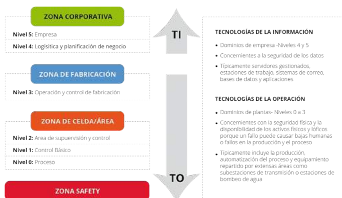
Marco lógico de jerarquía de control según el modelo de Purdue
